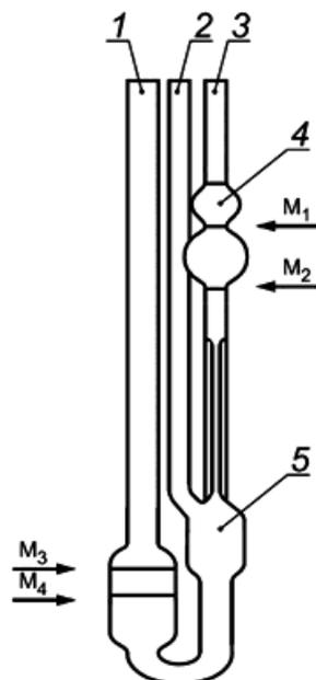
Рисунок Б.4 - Вискозиметр типов ВПЖТ-1, ВПЖ-1 (BS/IP/SL)
