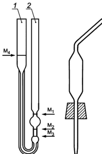
Рисунок Б.7 - Вискозиметр типа BS/IP/RF
