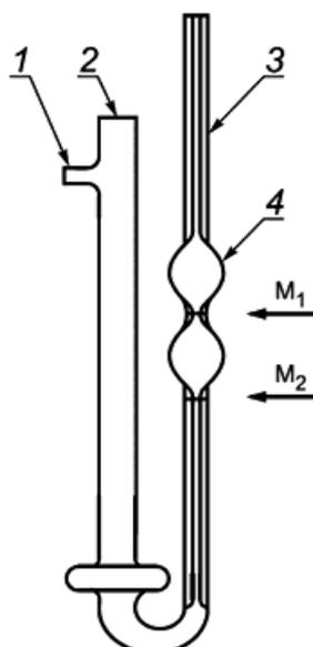
1 - трубка вискозиметра, на которую надевают резиновую трубку; 2 - колено, которое зажимается; 3 - колено, опускаемое в испытуемый нефтепродукт; 4 - расширение (должно быть ниже уровня жидкости в термостате)
