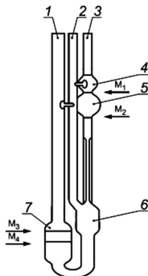
Рисунок Б.5 - Вискозиметр типа Убеллоде
