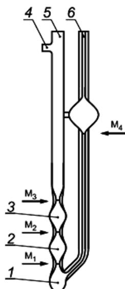
1 - резервуар; 2 - резервуар, по времени заполнения которого вычисляют вязкость; 3 - резервуар для контроля; 4 - трубка вискозиметра, на которую надевают резиновую трубку; 5 - колено, которое зажимается; 6 - колено, опускаемое в испытуемый нефтепродукт
