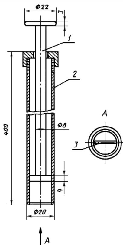
1 - шток с поршнем; 2 - корпус из тонкостенной трубки; 3 - проволока
