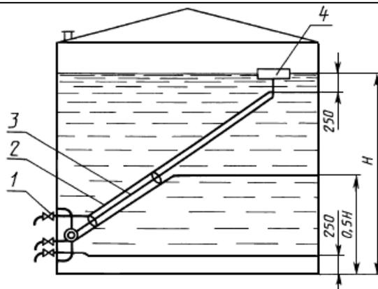
1 - кран; 2 - пробозаборные трубки; 3 - несущий рычаг; 4 - поплавок
