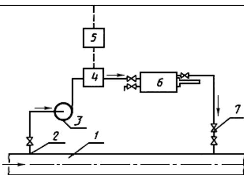
1 - трубопровод; 2 - пробозаборное устройство; 3 - насос; 4 - запорное устройство; 5 - регулятор;
