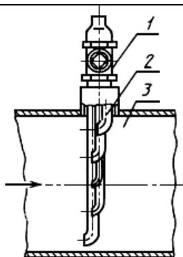
1 - вентиль; 2 - пробозаборная трубка; 3 - трубопровод
