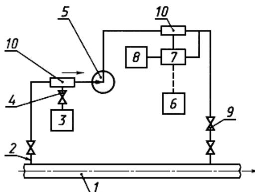
1 - трубопровод; 2 - пробозаборное устройство; 3, 8 - пробозаборники; 4 - кран для ручного отбора проб; 5 - насос; 6 - регуляторы; 7 - запорное устройство; 9 - обратный клапан; 10 - диспергаторы
