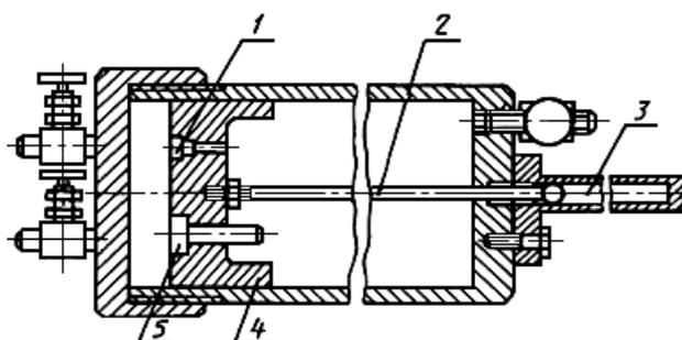
1 - предохранительный клапан; 2 - шток поршня; 3 - указатель положения поршня; 4 - поршень; 5 - перепускное устройство
