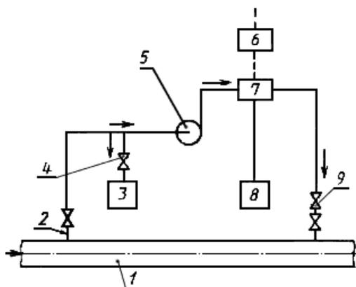
1 - трубопровод; 2 - пробозаборное устройство; 3, 8 - пробозаборник; 4 - кран для ручного отбора проб; 5 - насос; 6 - регулятор; 7 - запорное устройство; 9 - обратный клапан
