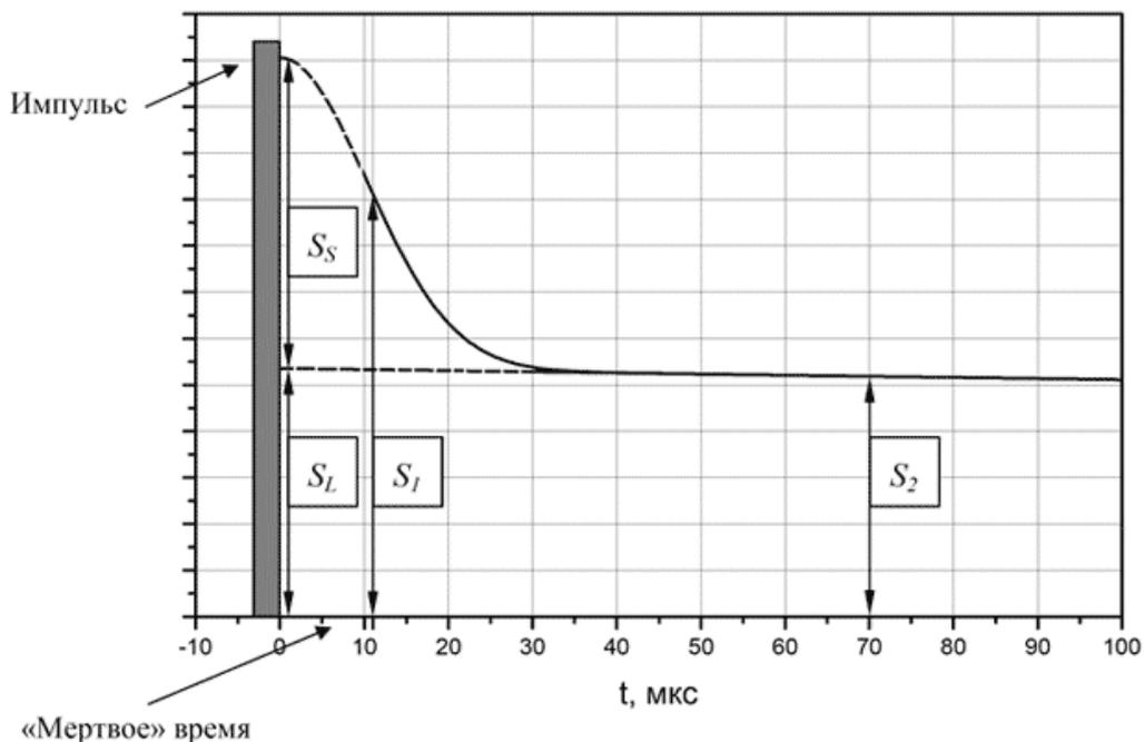
$S_L, S_G$  - амплитуда сигнала спада магнитной индукции жидкой и твердой фаз соответственно;  $S_T = S_L + S_G$  - амплитуда жидкой+твердой фазы;  $S_1, S_2$  - уровни сигнала магнитной индукции, измеренные при 11 и 70 мкс, соответственно
