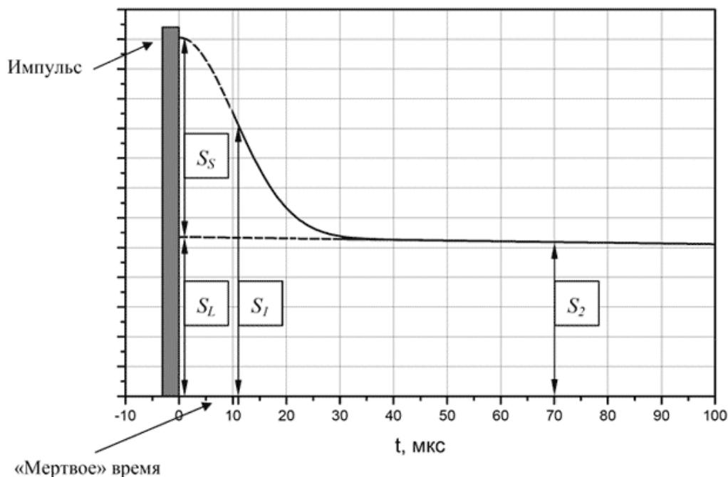
$S_L$ ,  $S_S$  - амплитуда сигнала спада магнитной индукции жидкой и твердой фаз соответственно;  $S_T = S_L + S_S$  - амплитуда жидкой+тврдой фазы;  $S_1$ ,  $S_2$  - уровни сигнала магнитной индукции, измеренные при 11 и 70 мкс, соответственно
